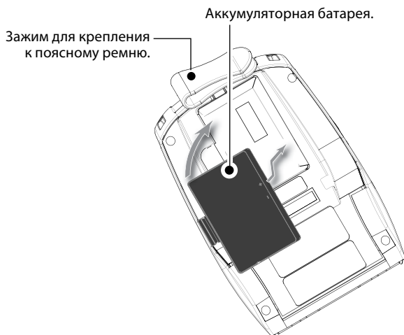
Рисунок 3. Установка аккумулятора (показан принтер QLн220)
