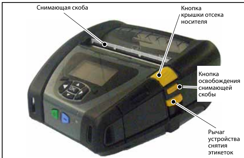
Рисунок 16. Активация снимающей планки (показана модель QLn420)
